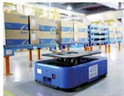
① 宝钢股份宝山基地运输的无人重载板架投入使用，基地到码头的物料运输实现远程操作，无人运输。
